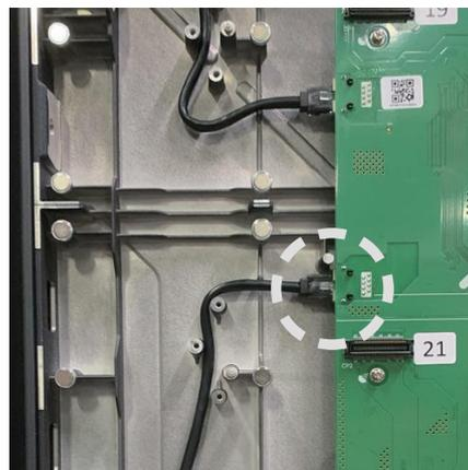
10. Schließen Sie die Stromkabel (rot/orange) der Gehäuse an. Beginnen Sie auf der Unterseite, fahren Sie dann mit der Oberseite fort.
